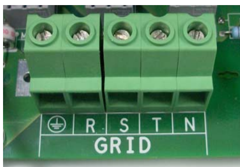
Fig.11 Morsettiera per connessione cavi AC
